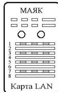
Для проверки качества оконцовки и целостности кабеля необходимо один его конец подключить к разъему «ТЕСТ», второй конец подключить к разъёму «Карта LAN» испытательной «заглушки», идущей в комплекте поставки. Если кабель обжат в разъемах правильно, то на дисплее появится информация где цифры в левом столбце будут соответствовать цифрам в правом столбце. Надписи: «Здесь» - ближний к тестеру конец кабеля, «Там» - удаленный от тестера конец кабеля.
