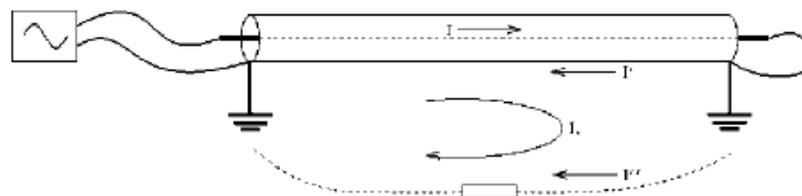
Рисунок 5-9 Схематическая диаграмма протекания сигнала при использовании метода подключения фаза-оболочка.
