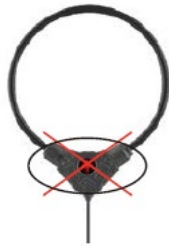
Рисунок 6-19 Область легкого возникновения помех у катушки гибких клещей
