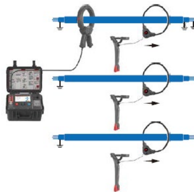
Рисунок 6-18 Идентификация кабеля под напряжением (метод токовых клещей)
