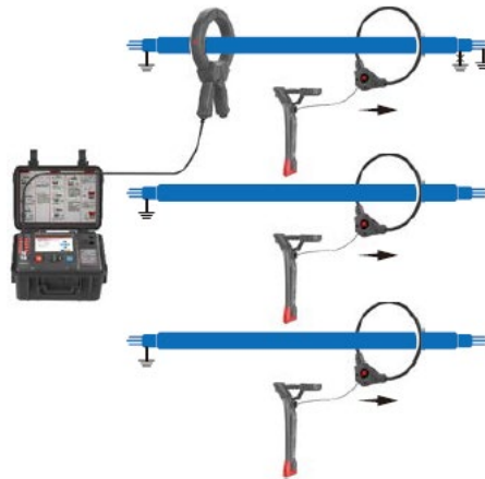
Рисунок 6-17 Идентификация обесточенного кабеля (метод прямого подключения)
