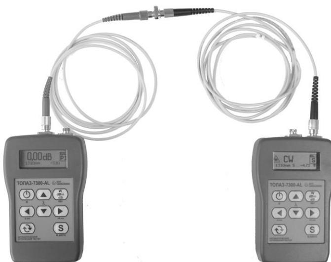
Рис.7. Измерение опорного уровня. Источник оптического сигнала на рисунке справа
