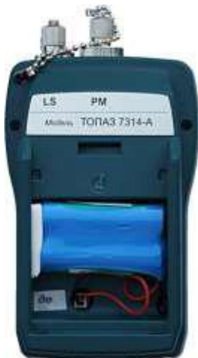
Рис.4. Вид прибора с открытой крышкой отсека аккумуляторной батареи
