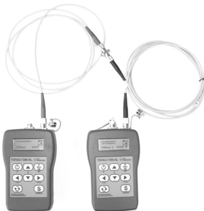
Рис.21. Калибровка приборов
