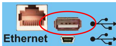
Рис. 7. Подключение компьютерной мыши к прибору.
