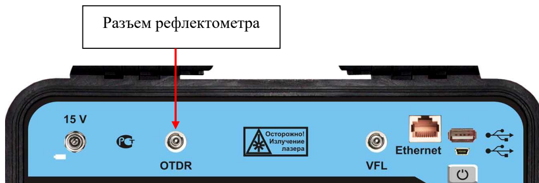
Рис. 12. Подключение оптического волокна.
