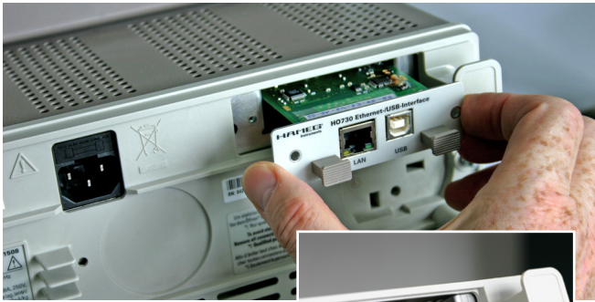
Abb. 2.3: Einsetzen der neuen Schnittstellenkarte
