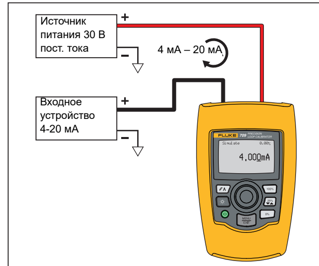
Рисунок 5. Соединения для моделирования тока
