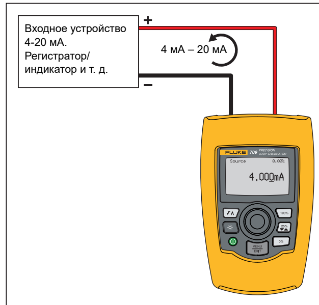
Рисунок 4. Соединения источника тока в мА
