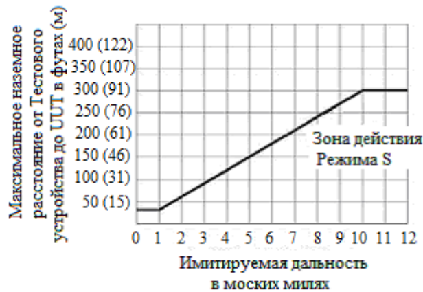
Рис. 132- Зона действия Режим S в пределах 12 м.м. имитируемой дальности
