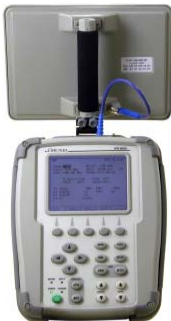
Рис. 5 – Установка антенны приемопередатчика
