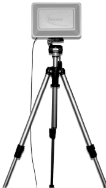
Рис. 131 – Тренога с установленной направленной антенной
