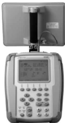
Рис. 129 - Направленная антенна, установленная на Тестовом устройстве
