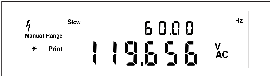
Рисунок А-1. Пример использования двойного дисплея для измерения переменного напряжения и частоты
