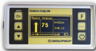
Проверку отбора производят в режиме генератора «ВЧ» или «ВЧ-ПАУЗА» (2 187,5 Гц), переключив приемник в режим «ПОИСК ТРАССЫ».
