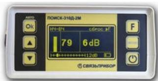
Сигнал «своего» кабеля отличается от «чужих» по величине и направлению. Чтобы уменьшить наведенный ток в соседних кабелях, используют низкую частоту генератора 273,5 Гц в режиме «НЧ-ВЧ».
