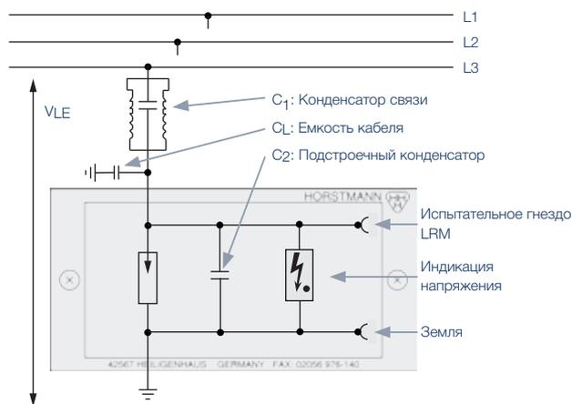
**Принцип построения интегрированной системы обнаружения напряжения**
