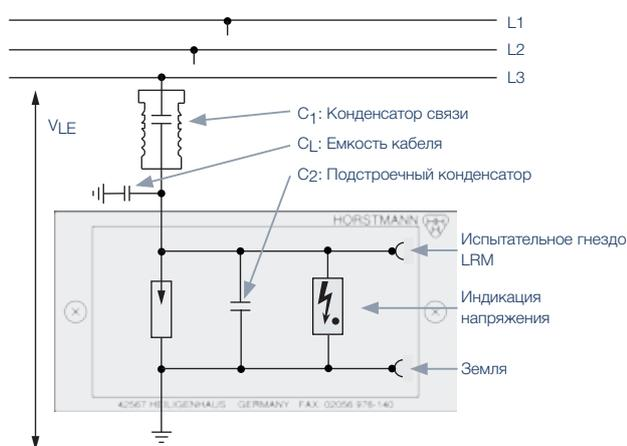
**Принцип построения интегрированной системы обнаружения напряжения**
