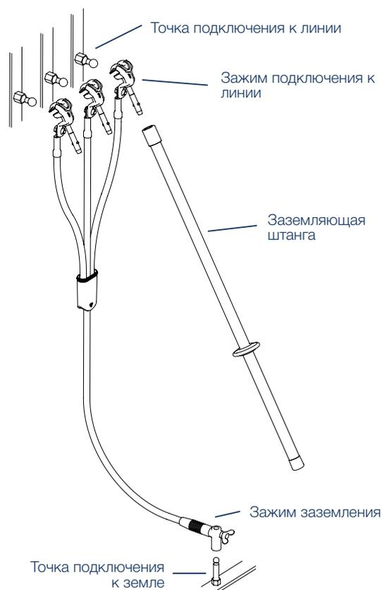
Длина кабелей заземления и короткого замыкания должна соответствовать распределительному устройству и расстоянию между точками подключения (не менее 1,2 расстояния). Если кабели слишком длинные (больше чем в 1,5 раза от расстояния), их необходимо зафиксировать с помощью изолирующего кабеля для предотвращения повреждений и травм в случае короткого замыкания.
