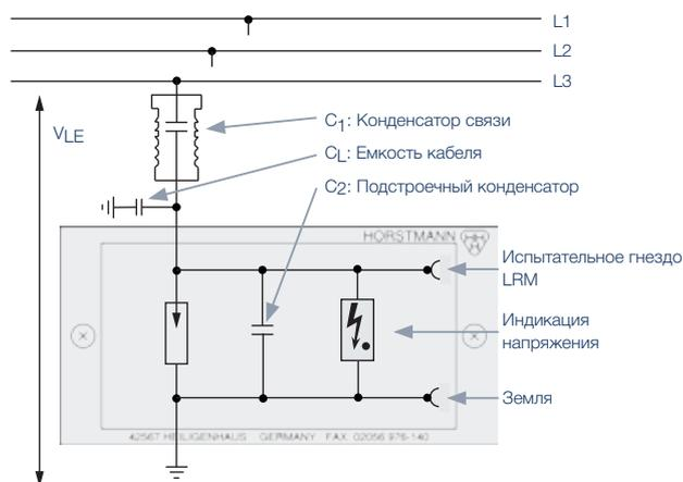
Принцип построения интегрированной системы обнаружения напряжения
