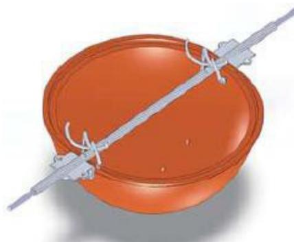
4. Соедините верхнюю полусферу с нижней полусферой. Чтобы гребень правильно вошел в паз, пожалуйста, совмещайте кабельные зажимы с напечатанным одинаковым номером (например, номером «2») на одной стороне каждой половины сферы.
