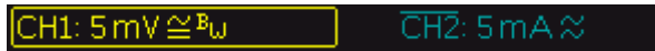
Рисунок 4-1 – Метки каналов: Выбран Канал 1, включена связь по постоянному току и ограничена полоса частот. Для канала 2 включена связь по переменному току и канал инвертирован.
