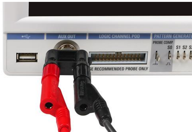
Рисунок 6-14 – Адаптер BNC/банан, подключенный к разъему AUX OUT
