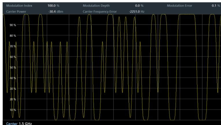
Рисунок 17-4 – Коэффициент модуляции сигнала с АМн-2
