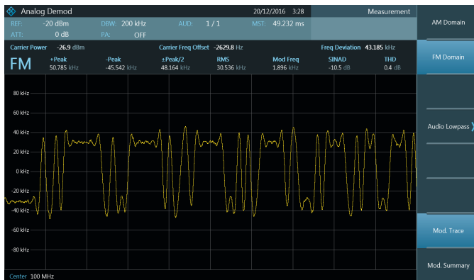
Опция R&S®FPC-K7: анализ ЧМ-модуляции
