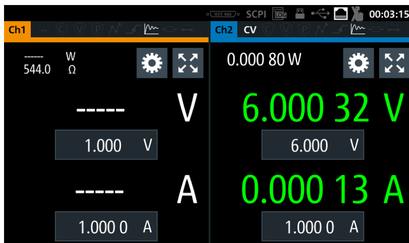
Рисунок 6-3 – Выход канала Ch2 в режиме стабилизации напряжения CV
