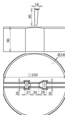
Бетонные опоры для молниеприемников Ø10 мм (длиной 1000 мм), для защиты небольших сооружений на плоских кровлях и для монтажа дистанционных держателей, например, изолированных кольцевых проводников с дистанционным держателем DEHNiso Ø16 мм, длиной до 675 мм (расстояние 0,8 м).
