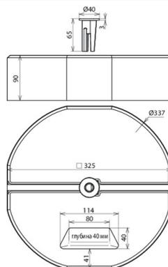
Бетонные опоры с резьбовым переходником, для молниеприемников Ø16 мм с резьбой М16, для защиты небольших сооружений на плоских кровлях.
