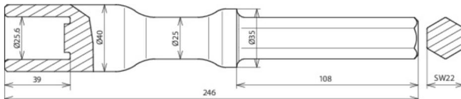
Исполнение для трубчатых заземлителей диаметром 25 мм из нержавеющей стали, для вибромолотов фирмы-изготовителя Atlas Copco.
