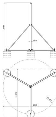
Разъемное исполнение для молниеприемников D40 высотой до 8000 мм или для опорных трубостоек DEHNiso-Combi, для монтажа на бетонные опоры (массой 17 кг).
