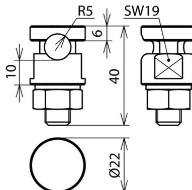
Винтовой зажим с пружинной шайбой и дополнительно нанесенным проводящим покрытием для подключения круглых проводников с плоскими профилями. Способность выдерживать токи молнии до 200 кА (10/350 мкс).
