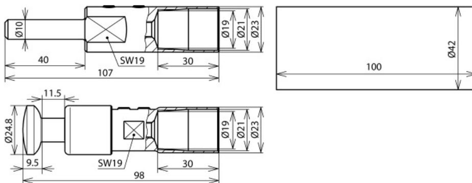
Установочный набор для соединения токоотвода HVI-long с обоих концов, соединение в зоне концевой заделки токоотвода с металлической трубостойкой с помощью насадки, соединение с другими элементами внешней молниезащиты или заземления с помощью соединительного элемента (вкл. 2 термоусадочные трубки).
