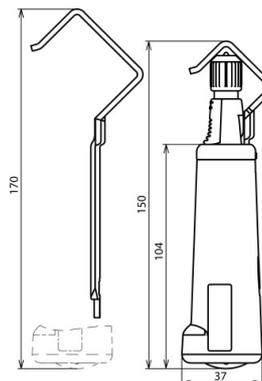
применяется для токоотводов HVI-light и HVI. Инструмент DEHNhelix состоит из рукоятки и съемной скобы (в зависимости от диаметра токоотвода).
