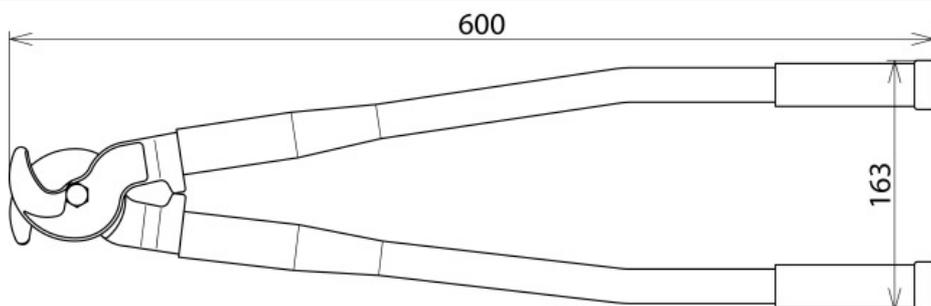
применяется для токоотводов HVI light, HVI (с внешним диаметром 20 и 23 мм) и HVI power (с внешним диаметром 27 мм), а также безопасного токоотвода CUI. Благодаря специальной конструкции инструмент позволяет обрезать также многожильные проводники, что облегчает подключение соединительных элементов.
