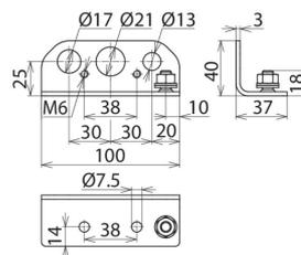
С тремя монтажными отверстиями для трех различных размеров DEHNgate, например, 1x 929 042 + 1x 929 057 + 1x( 929 043, 929 044, 929 045 или 929 059).
