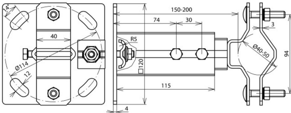
Крепление к ограждению с возможностью регулирования расстояния от 150 до 200 мм для молниеприемников D40, опорных труб DEHNcon-H и DEHNiso-Combi, с двойной накладкой двух круглых проводников Rd 8-10 мм.
