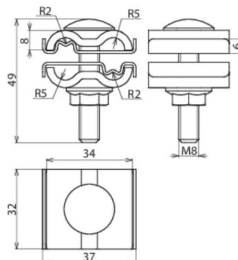
Соединительная клемма для подключения резинового коврика к системе заземления.
