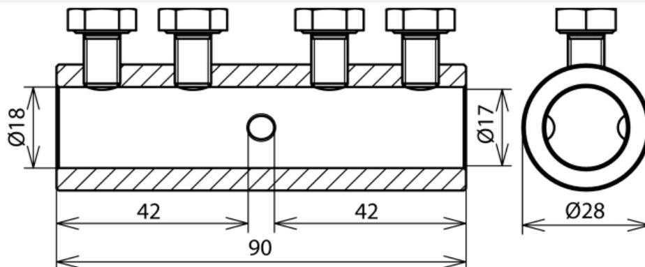
Соединительный элемент со стопорными язычками для соединения молниеприемников большей длины, чем транспортная длина, в комплекте с 4 болтами М8 (для защиты крепления от ослабления).
