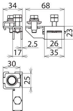
для использования с полосой (арт. 540 901), для проводников сечением 4-25 мм<sup>2</sup> (одно- или многожильный кабель).
