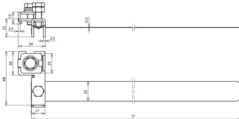
Ленточный хомут для электрического контакта с трубами. Ленточный хомут с защитой от самораскручивания болтов согласно требованиям EN 62305-3 прилож. 2 (VDE 0185-305-3 пр. 2).
