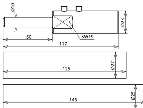
в зоне концевой заделки к другим частям внешней системы молниезащиты или системы заземления. В комплект входят две термоусадочных трубки и две кабельных стяжки.
