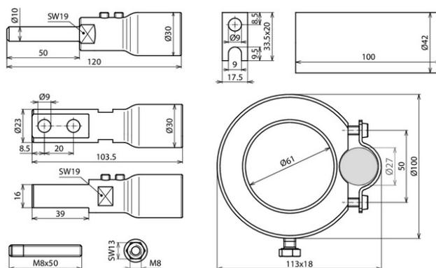
Установочный набор для монтажа токоотвода HVI-power для крепления к трубостойке GFK / Al состоит из соединительного элемента, штифтов с резьбой, термоусадочных трубок, кабельных стяжек и фиксирующего кольца с держателем (Ø27 мм).
