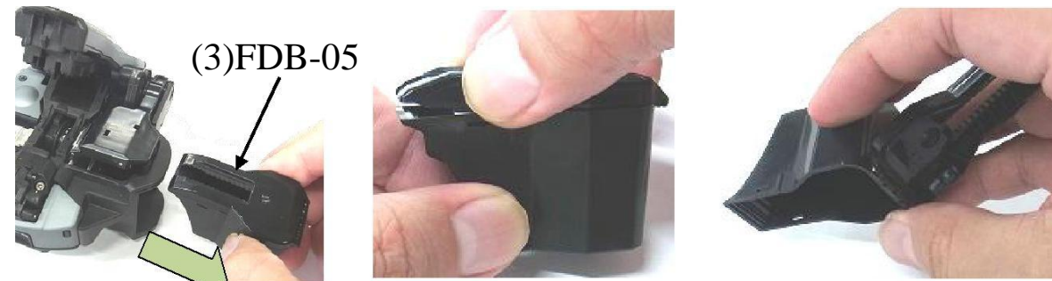
Рис.5-3 Очистка контейнера для сколотого волокна
