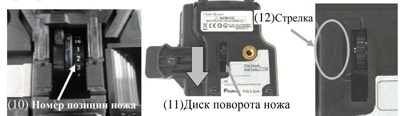
Рис.6-2 Номер позиции ножа и диск поворота ножа
