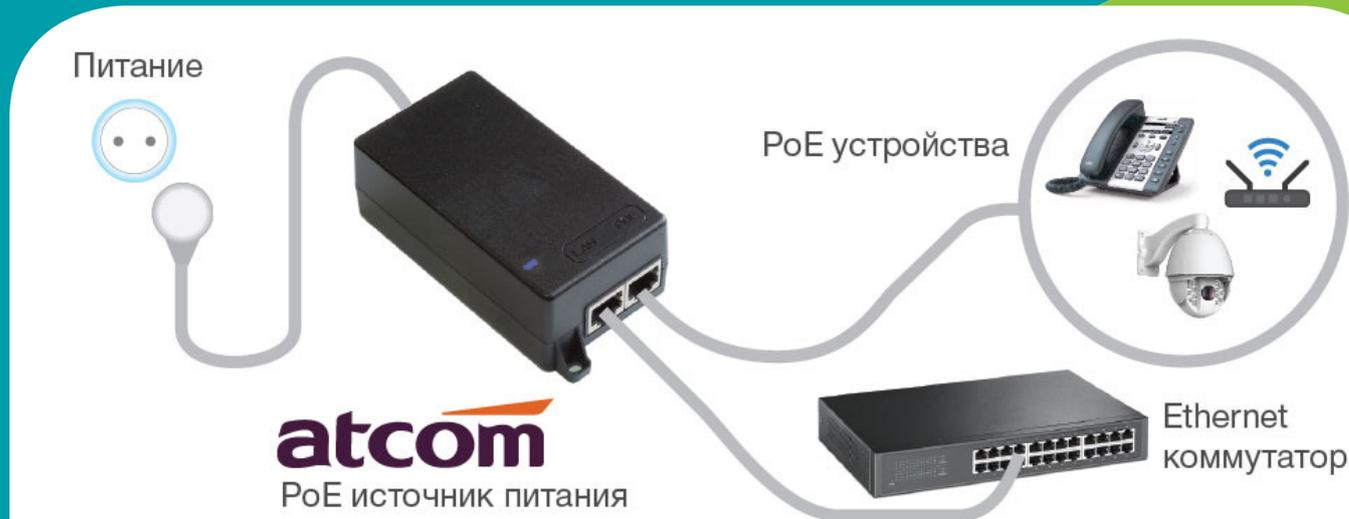
POE-инжекторы — простой и недорогой способ добавить в информационный кабель типа «витая пара» электропитание для POD-устройств, совместимых со стандартом Power-over-Ethernet:
