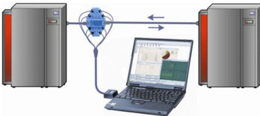
Рис 3.1. Подсоединение AnyTest к тестируемой линии в режиме монитора.
