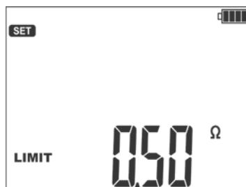
Диапазон установки лимита соответствует диапазону функции: от 0,01 Ом до 999 Ом. Значение лимита устанавливается аналогично, как для  $R_{ISO}$ .
