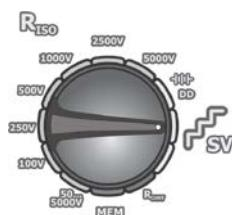
Установите поворотный переключатель выбора функций в положение **SV**. Прибор находится в режиме измерения напряжения
