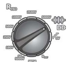
Установите поворотный переключатель выбора функций в положение **DD**. Прибор находится в режиме измерения напряжения
