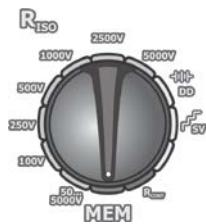
Установите поворотный переключатель выбора функций в положение **MEM**.
