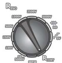
Установите поворотный переключатель выбора функций в положение  $R_{CONT}$ .
