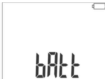
Аккумулятор сильно разряжен, все измерения блокируются. Измеритель автоматически отключится через 5 с.
