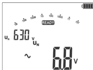
Нажимая клавишу **MENU** можно перейти к выбору времени для расчета коэффициентов абсорбции ( $t_1$ ,  $t_2$ ,  $t_3$ ) и общему времени измерения  $t_n$ , тока  $I_{iso}$  и лимитов (только MIC-5010).
