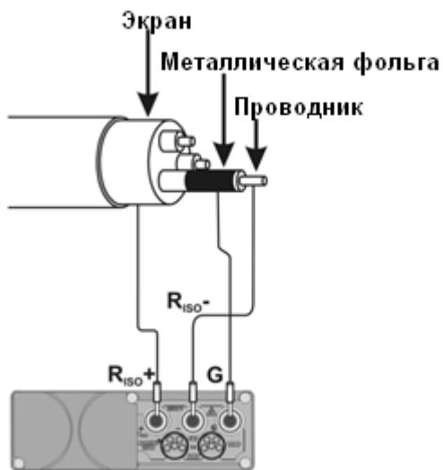
Таким же способом подключается разъем **G** при измерение сопротивления между двумя жилами к третей, не участвующей в процессе измерения.
