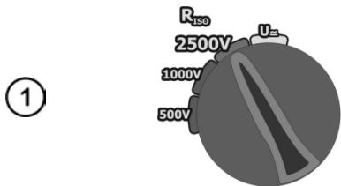
Установите поворотный переключатель в режим  $R_{iso}$  для одного из стандартных напряжений
