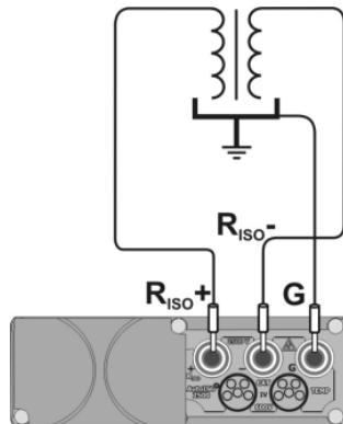
При измерении сопротивления между жилой кабеля и экраном, влияние поверхностных токов (особое влияние оказывают при сложных погодных условиях) исключают присоединением
