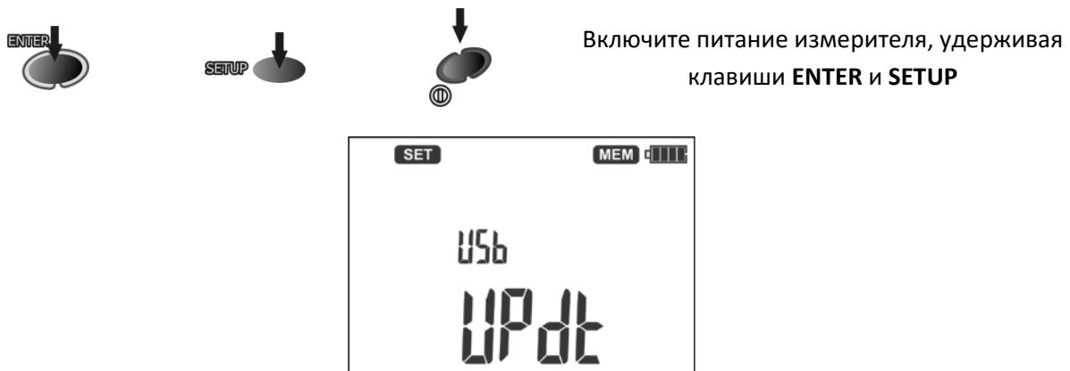
После подключения измерителя к компьютеру с помощью USB кабеля, следуйте инструкциям на дисплее.
