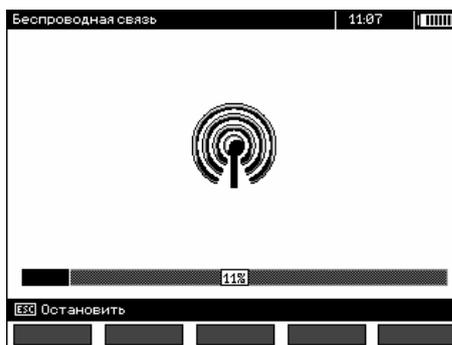
После завершения процесса поиска измеритель покажет список доступных клавиатур (другие устройства: мобильные телефоны, кпк, компьютеры, и т.д. не отображаются).
