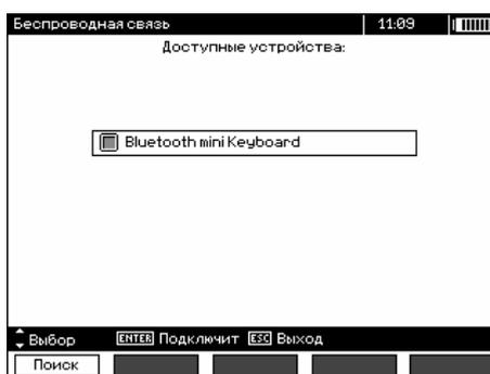
В списке доступных устройств необходимо выбрать одну из клавиатур и нажать клавишу "ВВОД - Соединить" - измеритель отображает полоску процесса обратного отсчета на 30 секунд. За это время необходимо ввести на клавиатуре PIN-код измерителя и подтвердить его клавишей ВВОД, также расположенной на клавиатуре.
