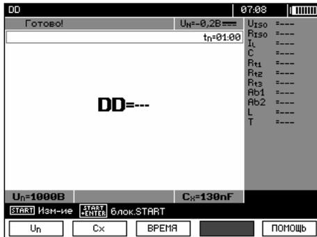
С помощью клавиш **F1** **Un**, **F2** **Cx** и **F3** **ВРЕМЯ** установите испытательное напряжение, емкость объекта и время измерения (1 мин...60 мин) так же, как в разделе 3.2.2
