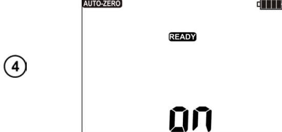
**AUTO-ZERO** и **ON** отображены на дисплее, подтверждающие завершение процесса компенсации (калибровки) сопротивления измерительных проводников.
