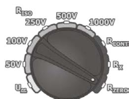
Установите поворотный переключатель в режим  $R_{ZERO}$
