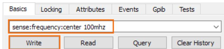
Команда `SENSE:FREQUENCY:CENTER` изменяет значение центральной частоты прибора R&S FPC1000.
