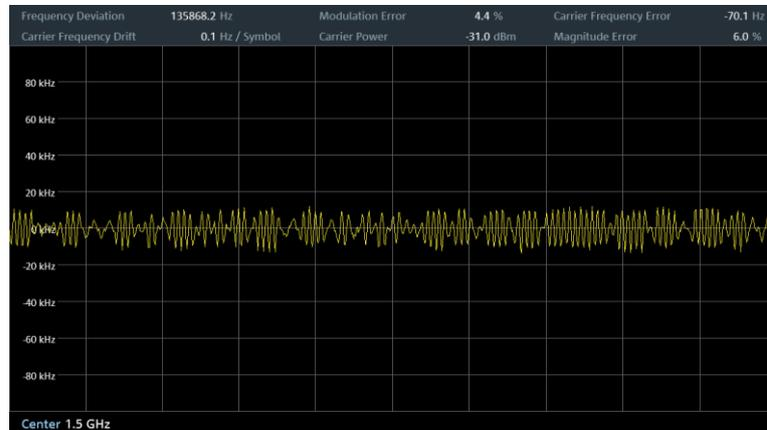
Рисунок 12-6 – Ошибка модуляции сигнала с ЧМн-2
