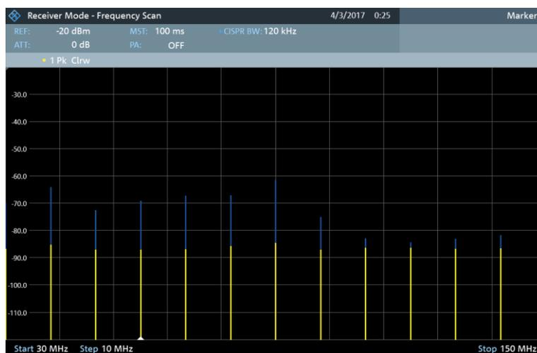
**Рисунок 10-2 – Сканирование на фиксированных частотах в диапазоне от 30 до 150 МГц с шагом 10 МГц**
