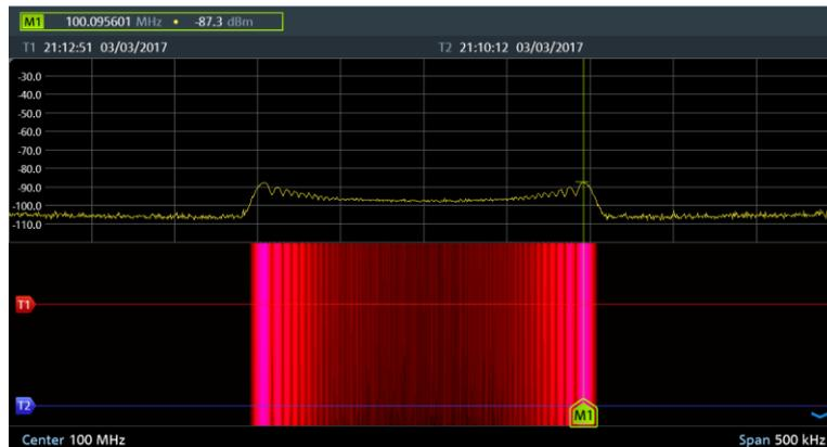
Рисунок 9-5 – Временные линии и маркеры на спектрограмме
