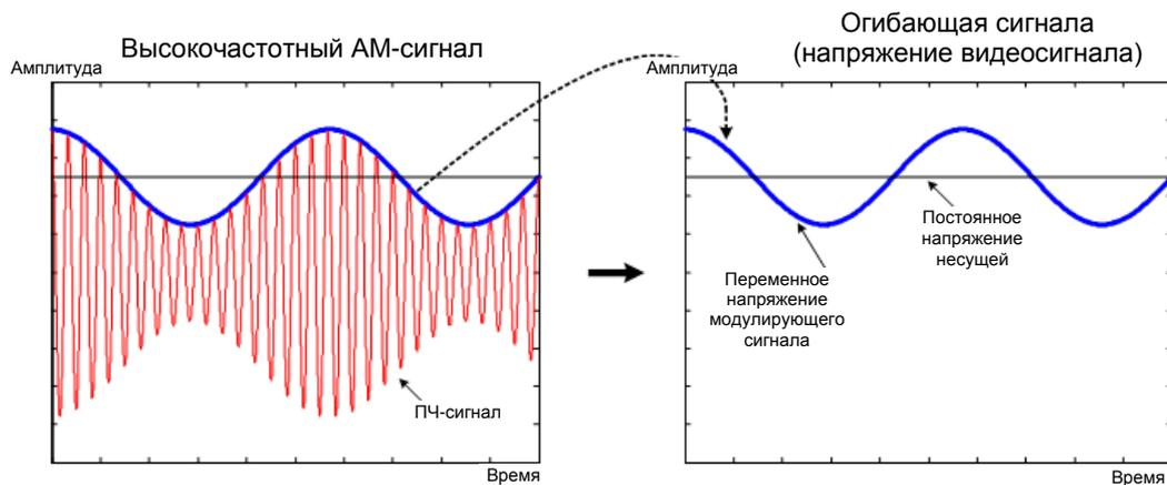
Рисунок 9-10 – Напряжение видеосигнала на примере АМ-сигнала
