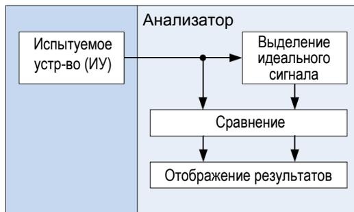
Рисунок 12-1 – Принцип демодуляции
