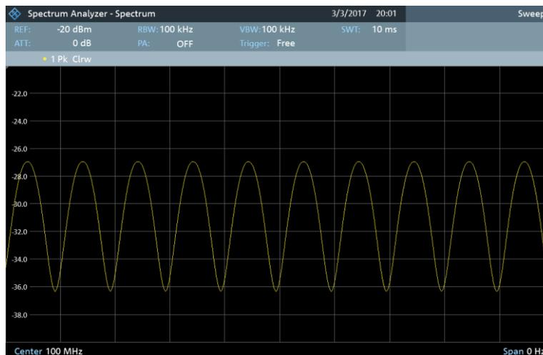
*Рисунок 9-3 – Отображение сигнала во временной области*
