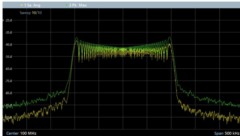
Рисунок 9-13 – Отображение двух кривых и информации о кривой над областью диаграммы
