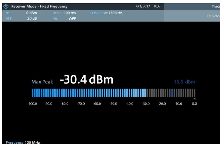
Рисунок 10-1 – Полосовая диаграмма с результатами измерения на фиксированной частоте, включая информацию о максимальных значениях
