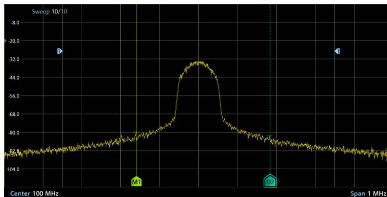
Рисунок 9-18 – Линии диапазона поиска с помощью маркеров
