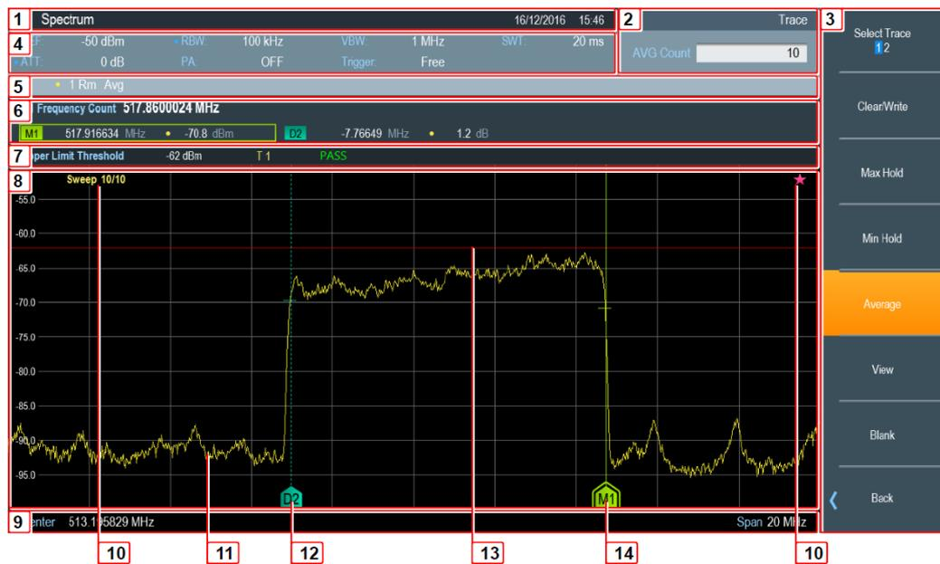
Рисунок 4-7 – Компоновка экрана в режиме отображения спектра
