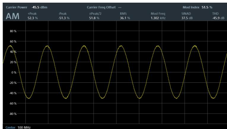
Рисунок 11-1 – Отображение осциллограммы AM-сигнала
