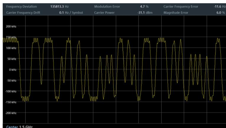
Рисунок 12-5 – Девиация модуляции сигнала с ЧМн-2
