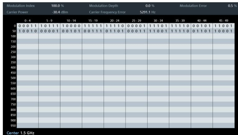
Рисунок 12-3 – Поток символов сигнала с АМн-2
