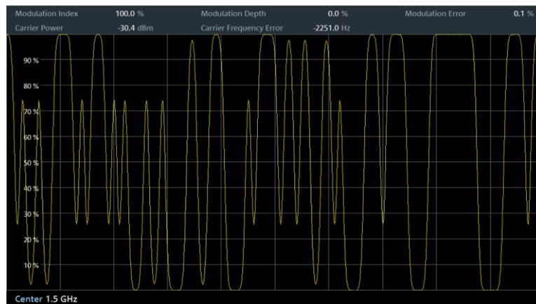
Рисунок 12-4 – Коэффициент модуляции сигнала с АМн-2
