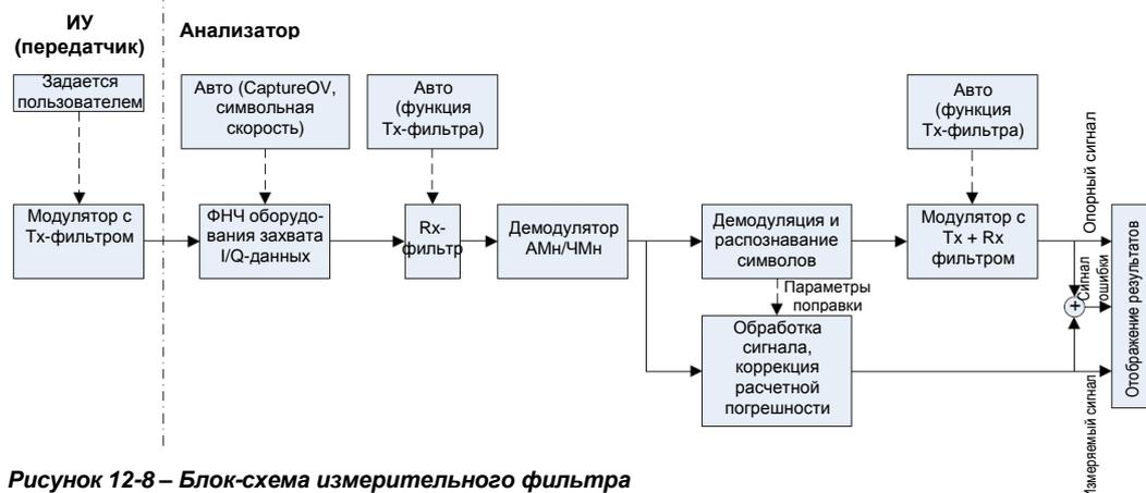
Рисунок 12-8 – Блок-схема измерительного фильтра
