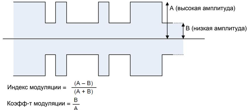
Рисунок 12-7 – Вычисление индекса и коэффициента модуляции
