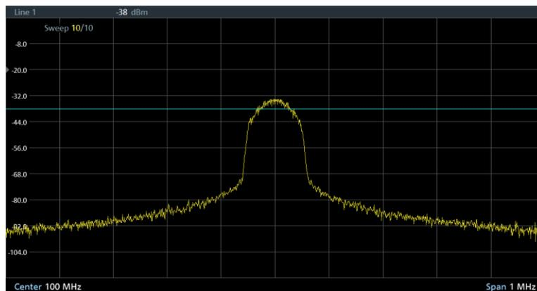
Рисунок 9-19 – Линия индикации на уровне -38 дБмВт
