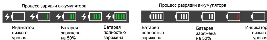
Рисунок 3-2 – Процесс зарядки и разрядки аккумулятора
