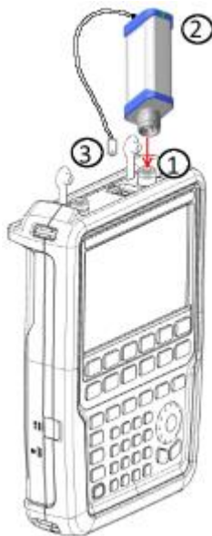
Рисунок 7-8 – Набор для калибровки R&S ZN-Z103
