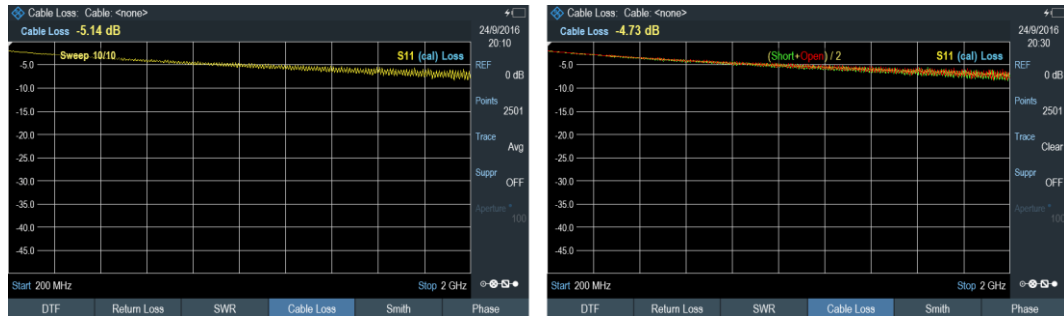
Рисунок 7-6 – Однопортовое измерение потерь в кабеле
