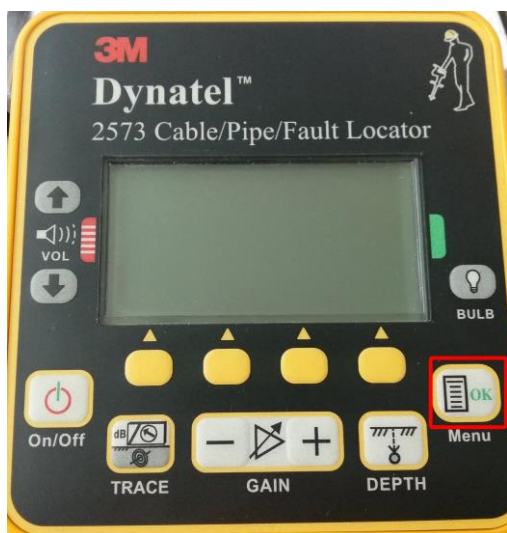
Рисунок 14. Кнопка ОК на маркероискателе ЗМ
