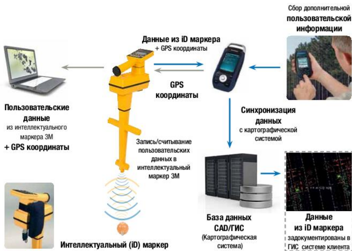
Рисунок 1. Принципиальная схема системы АИСУ МПК
