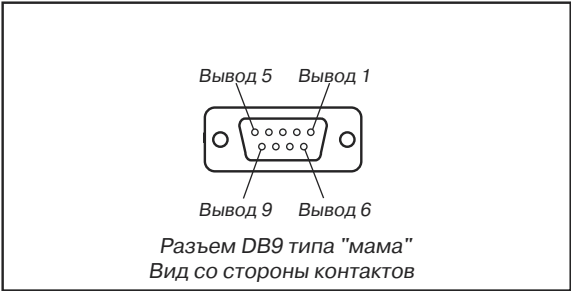
Рисунок 3: Номера выводов порта терминала RS-232
