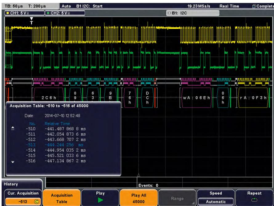
Сегментированная память объемом 460 млн отсчетов позволяет записывать и анализировать пакетные сигналы с использованием до 45 тыс. сегментов.
