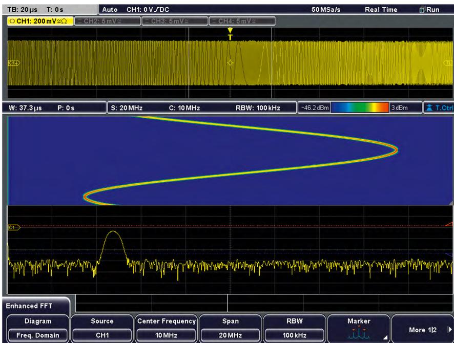
Три различных представления измеренного сигнала: во временной области (сверху), с помощью спектрограммы (в центре) и в частотной области (снизу).
