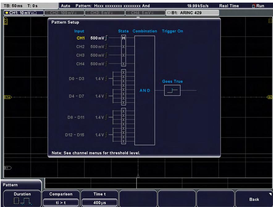
Быстрое обнаружение сложных последовательностей с помощью функции запуска по шаблону.
