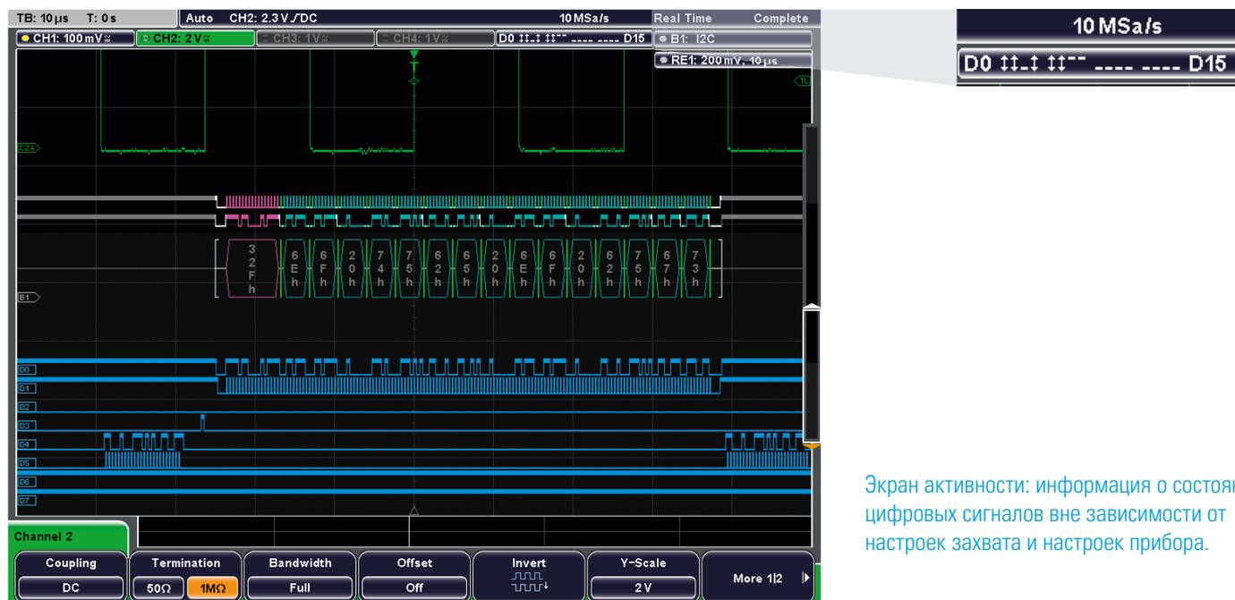
Экран активности: информация о состоянии цифровых сигналов вне зависимости от настроек захвата и настроек прибора.
