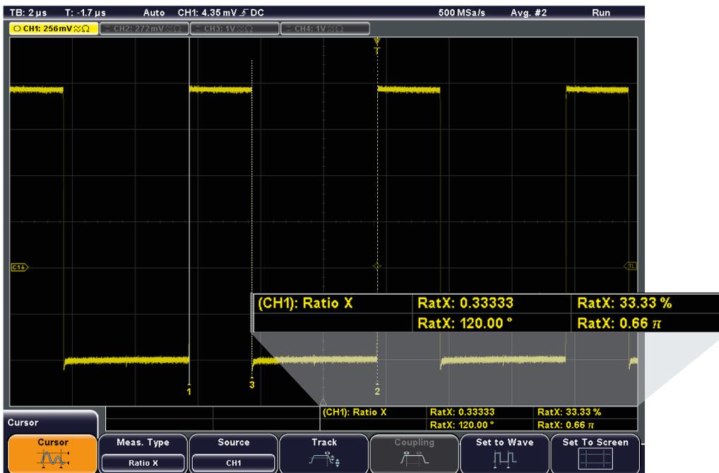
Специальное измерение с помощью курсора: использование трех курсоров для определения коэффициента заполнения импульсного сигнала.
