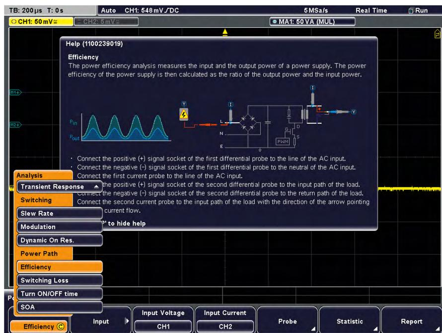
Функция интерактивной справки позволяет проводить измерения быстро и просто.
