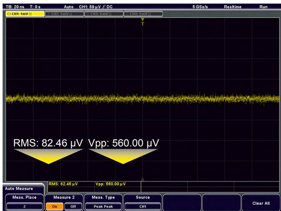
Исключительно низкий уровень собственного шума даже при вертикальной чувствительности по входу 1 мВ/дел в полной полосе пропускания и при полном разрешении.
