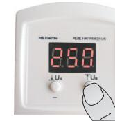
Для изменения верхнего предела нажмите кнопку **TU<sub>B</sub> (+)** и удерживайте в течении 2 секунд - индикатор в мигающем режиме (частота мигания выше чем при аварийном режиме) высветит значение предела установленное ранее. Кнопками (-) или (+) выставьте нужный предел.
