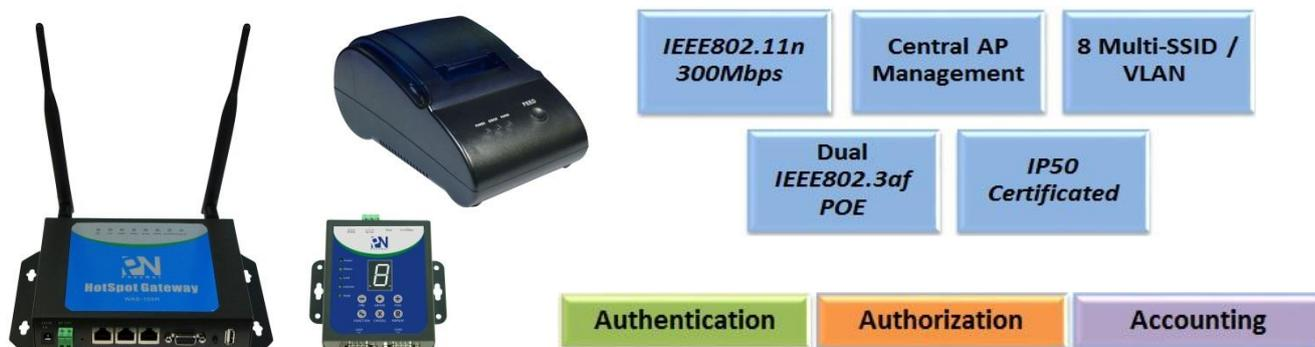
**PheeNet GAP-105R** - точка доступа Wi-Fi стандарта 802.11n для использования внутри помещений со встроенной функцией AAA шлюза (Authentication, Authorization, Accounting).
