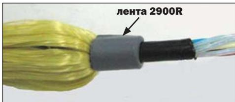
*Примечание – Предварительно участок наложения ленты 2900R обезжирить и зачистить шкуркой шлифовальной, полиэтиленовую крошку удалить.*
