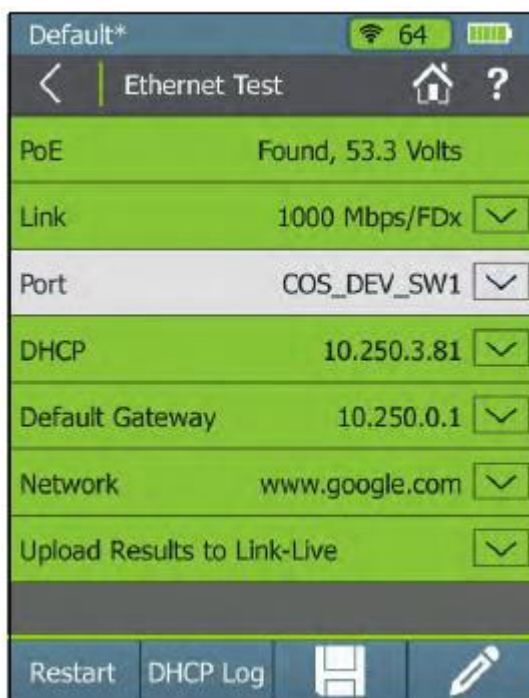
Рисунок 32. Экран тестирования Ethernet (Ethernet Test).
