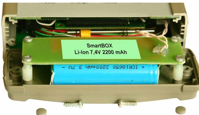
При подключении сетевого адаптера происходит быстрая зарядка аккумуляторов. Время полной зарядки не превышает 4-х часов. Индикация процесса осуществляется светодиодом на передней панели прибора.
