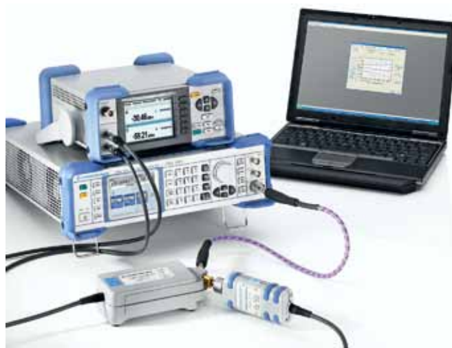
Измерительная установка для калибровки преобразователя мощности NRP-Z55
