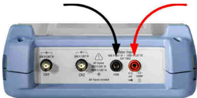
Рис. 4-1: Входы мультиметра для подключения щупов
